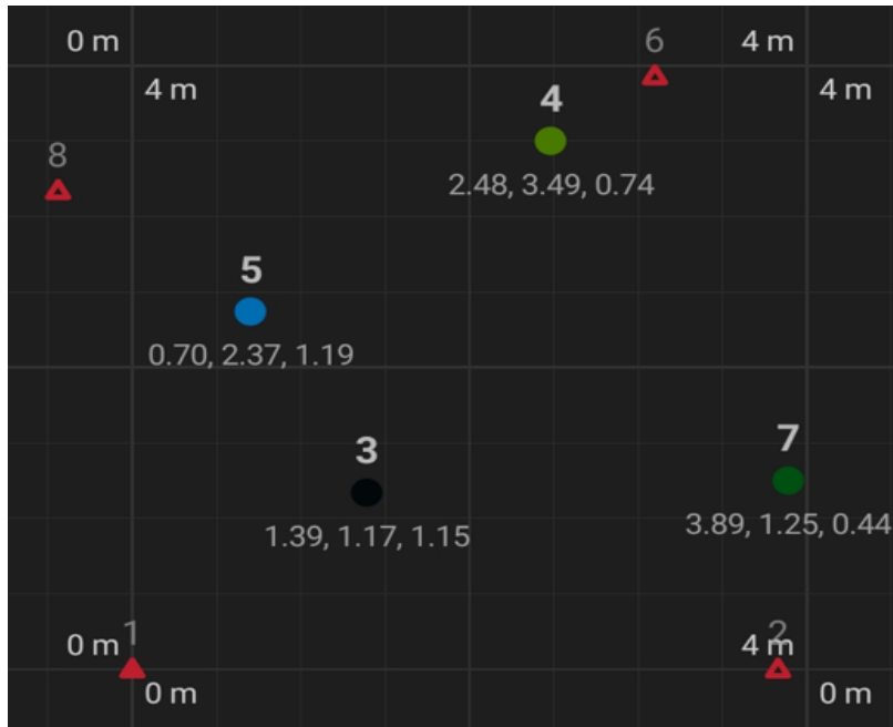
Şekil 4. 9. 4 Anchor ve 4 Tag ile uygulama
