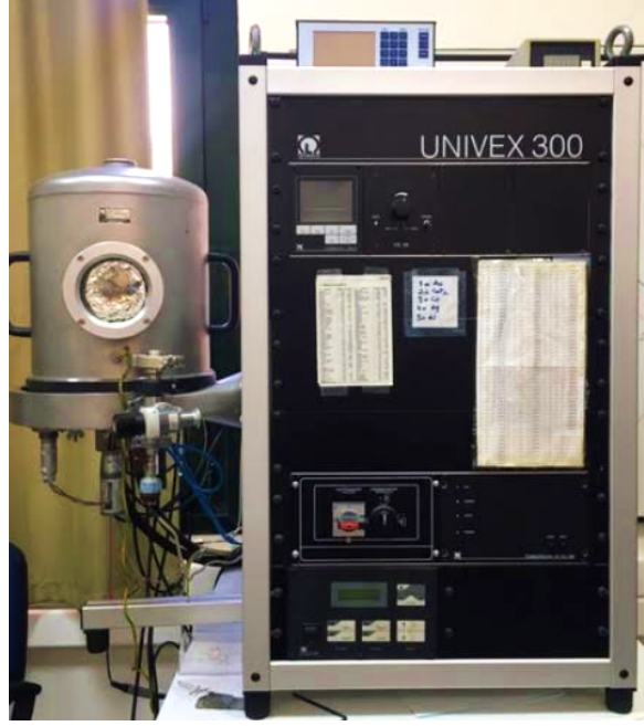
Şekil 5. İYTE Uygulamalı Kuantum Araştırma Merkezi' nin altyapısında bulunan fiziksel buharlaştırma sisteminin fotoğrafı
