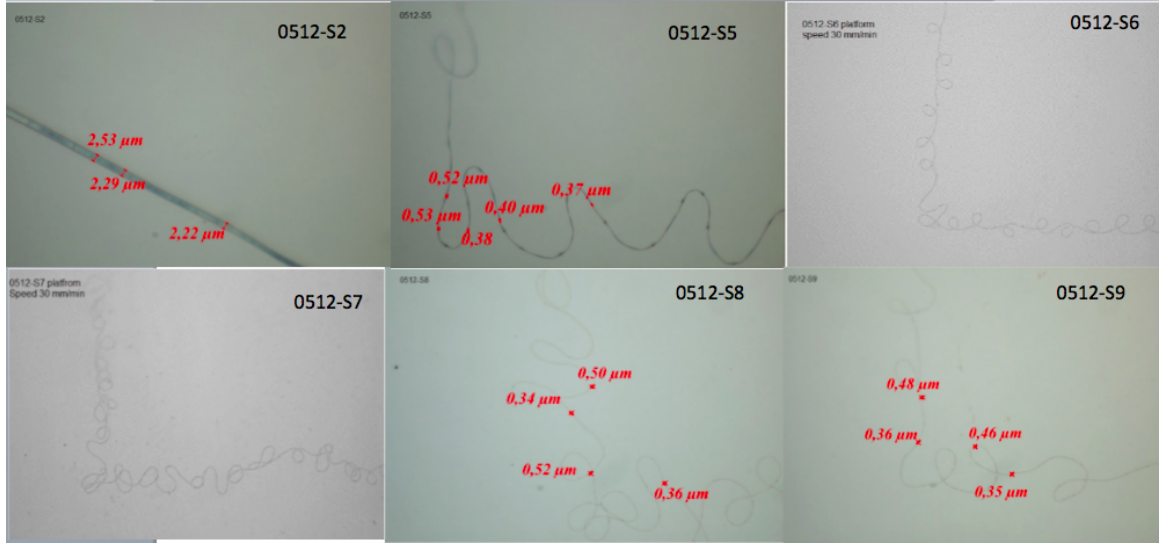
Şekil 26. Tablo 6' ya göre üretilen örneklerdeki fiberlerin yapısı ve kalınlıkları
