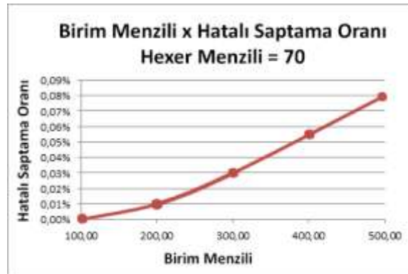
Şekil 4.3.9: Hexer birimin menzilini, kat yüksekliğinden daha kısa yapmak, hatalı saptama (gruplama) oranını neredeyse 0'a indiriyor
